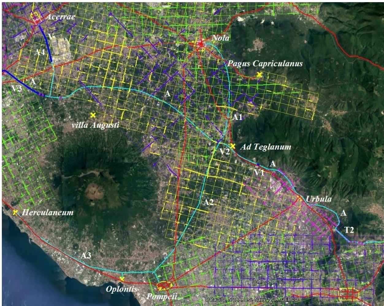
Fig. 3 – Segmenti 3 e 4. A = Aqua Augusta del Serino; A1 = diramazione per Nola ; A2 = diramazione per Pompeii ; A3 = possibile diramazione per Herculaneum ; A4 = diramazione per Acerrae ; T2 = traforo del monte Paterno; V1 = mura d'Arce; V2 = località Ponte Tirone; V3 = grande ponte canale di Pomigliano d'Arco; V = possibile tratto su arcate.
