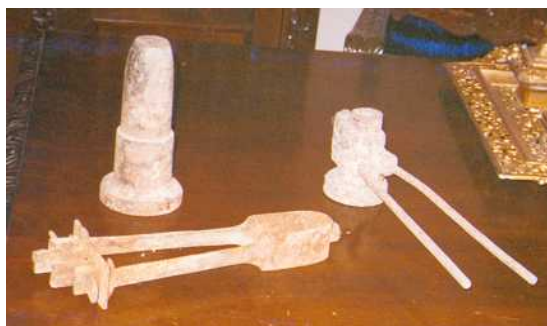
Fig. 9 – Attrezzi in ferro per la lavorazione del vetro.
