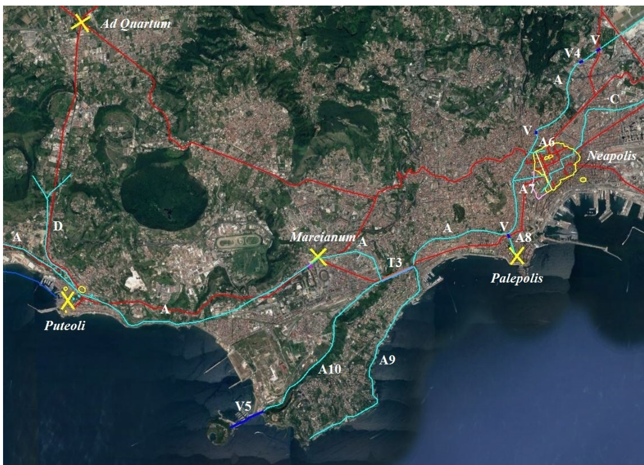
Fig. 9 – Segmenti 7 e 8. A = Aqua Augusta del Serino; V4 = Ponti Rossi; V5 = ponte-canale sul mare; V = possibili tratti su arcate; T3 = traforo di Fuorigrotta; A6 = prima diramazione per Neapolis ; A7 = seconda diramazione per Neapolis ; A8 = diramazione per Palepolis ; A9 = diramazione per Pausilypon ; A10 = diramazione per Nisida ; C = acquedotto del Bolla; D = acquedotto del Gauro.
